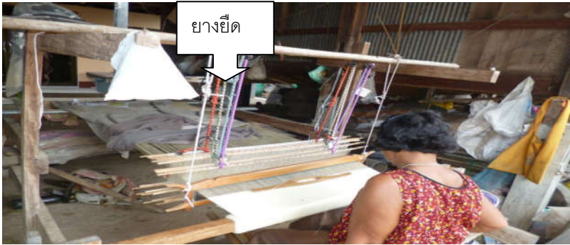
ภาพที่ 8 การทอผ้าลายลูกแก้ว พิมพ์ 5 เขว 2 เอื้อ เขาหนาอยู่หลังเขาขีดโดยใช้สายยางมัดให้ความยืดหยุ่นเพื่อช่วยเหยียบและยกตะกอ
