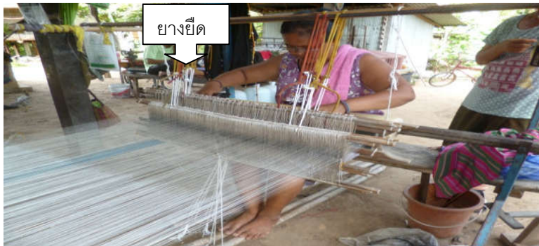
ภาพที่ 4 การใช้ยางยืด เพื่อความยืดหยุ่นโยงเขาฟืมด้วยยางยืดเพื่อช่วยในการเหยียบและยกตะกอก
