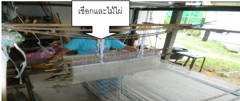
ภาพที่ 6 การทอผ้าลายลูกแก้ว ฟีม 5 เขา 2 เอื้อ เขาหนาอยู่หลังเขาขีด โดยใช้ไม้ไผ่เหล่านำให้ยึดหยุ่นเพื่อช่วยเหยียบ และยกตะกอก
