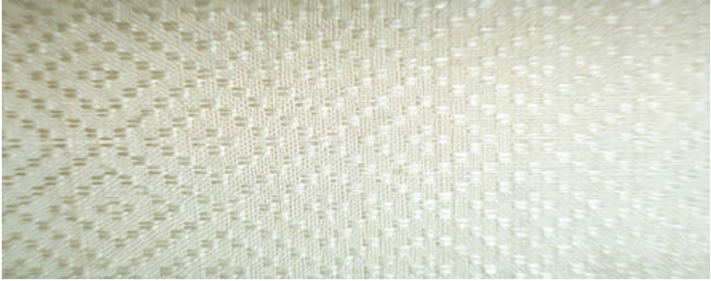
ภาพที่ 7 ผ้าลายลูกแก้ว ด้านบนขณะทอบนที่ทอผ้า พิม 4 เขา 2 เอื้อ
